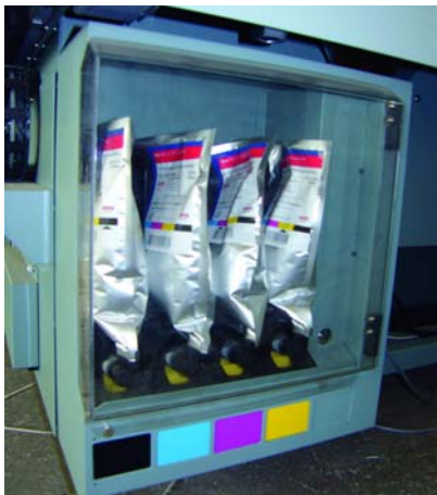
Чернила Ose IJC255, произведенные компанией Fujifilm- Sericol, упакованы в 2-литровые пакеты. Во время печати пакеты меняются быстро и без особых трудностей
