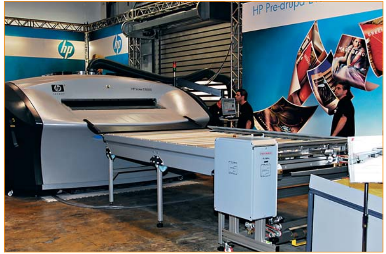
Мощная машина для высокоскоростной (до 400 кв. м/ч) печати UV-отверждаемыми чернилами HP Scitex TJ8500 со встроенной линией послепечатной обработки изображений.
