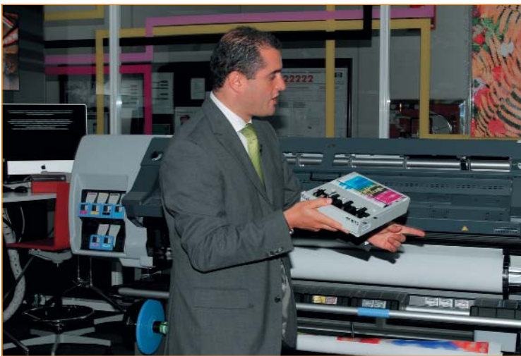
Новые «зеленые» принтеры, в отличие от своих сольвентных собратьев, не нуждаются в регулярной чистке печатающих головок. На фото: специалист компании HP демонстрирует журналистам устройство автоматической системы чистки печатающих головок HP 789.
